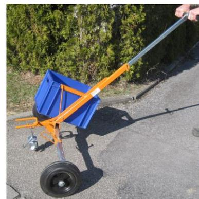
Placer l'outil de préhension dans le trou central du tampon, sécuriser. Ajuster l'entreaxe en fonction du diamètre du tampon. Rallonger le manche pour obtenir une fonction de levier optimale. Avancer le lève-tampons vers l'outil. Prendre l'outil de préhension par le crochet, appuyer sur le manche pour soulever et retirer le tampon. Pour remettre le tampon procéder dans le sens inverse.
