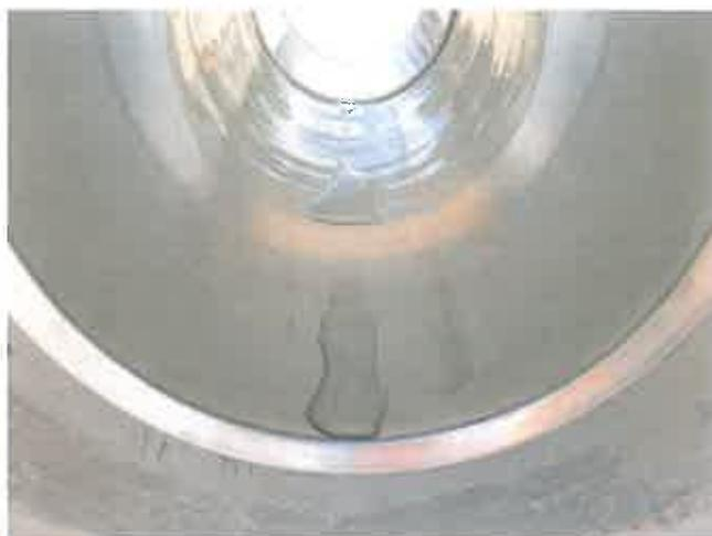
Bild 10: Circum-LEM im Betonrohr, DN 300 nach 60 Zyklen
