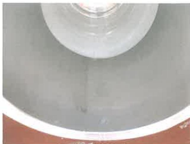
Bild 11: Circum-LEM im Steinzeugrohr, DN 300 nach 60 Zyklen
