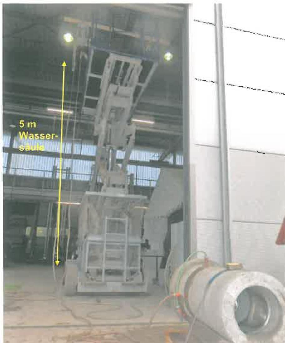
Bild 9: Prüfaufbau für die Dichtheitsprüfung mit Außenwasserdruck mit 0,5 bar (5m Wassersäule), hier für die Circum-LEM im Betonrohr
