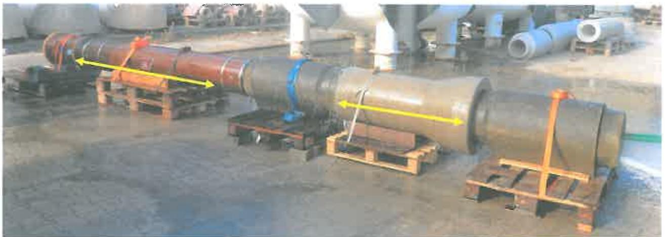
Bild 2: Prüfstrecke; gelbe Pfeile zeigen die Bereiche mit dem Liner und den Linerendmanschetten
