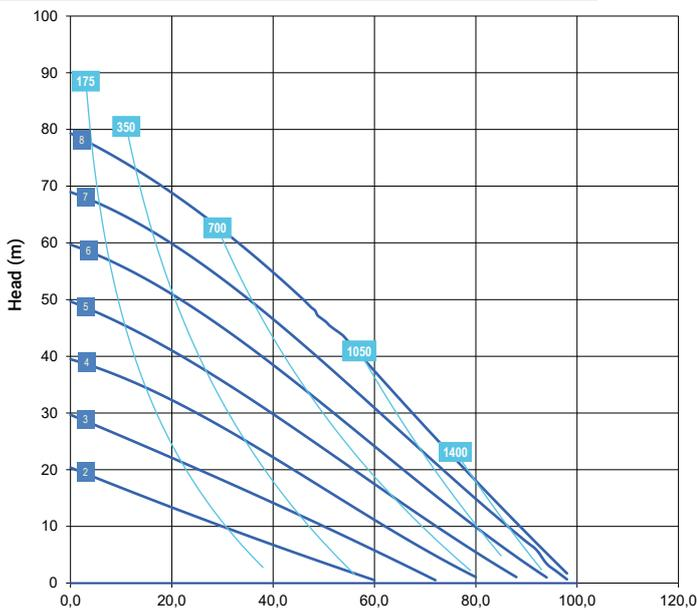
\* Die Kurven und Leistungen beziehen sich auf Pumpen mit Tauchsaugung und freiem Druckanschluss, mit Wasser bei einer Temperatur von 20 °C und variieren je nach Materialzusammensetzung.
