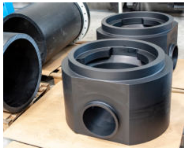
Bild 1: Gefräster Grundkörper der Reinert-Ritz Molchschleuse Quick-Pig
