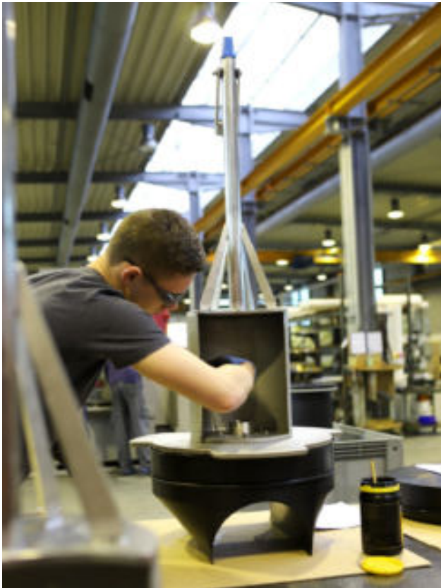
Bild 2: Montage des Sender-Einsatzes für eine Quick-Pig-Molchstation
